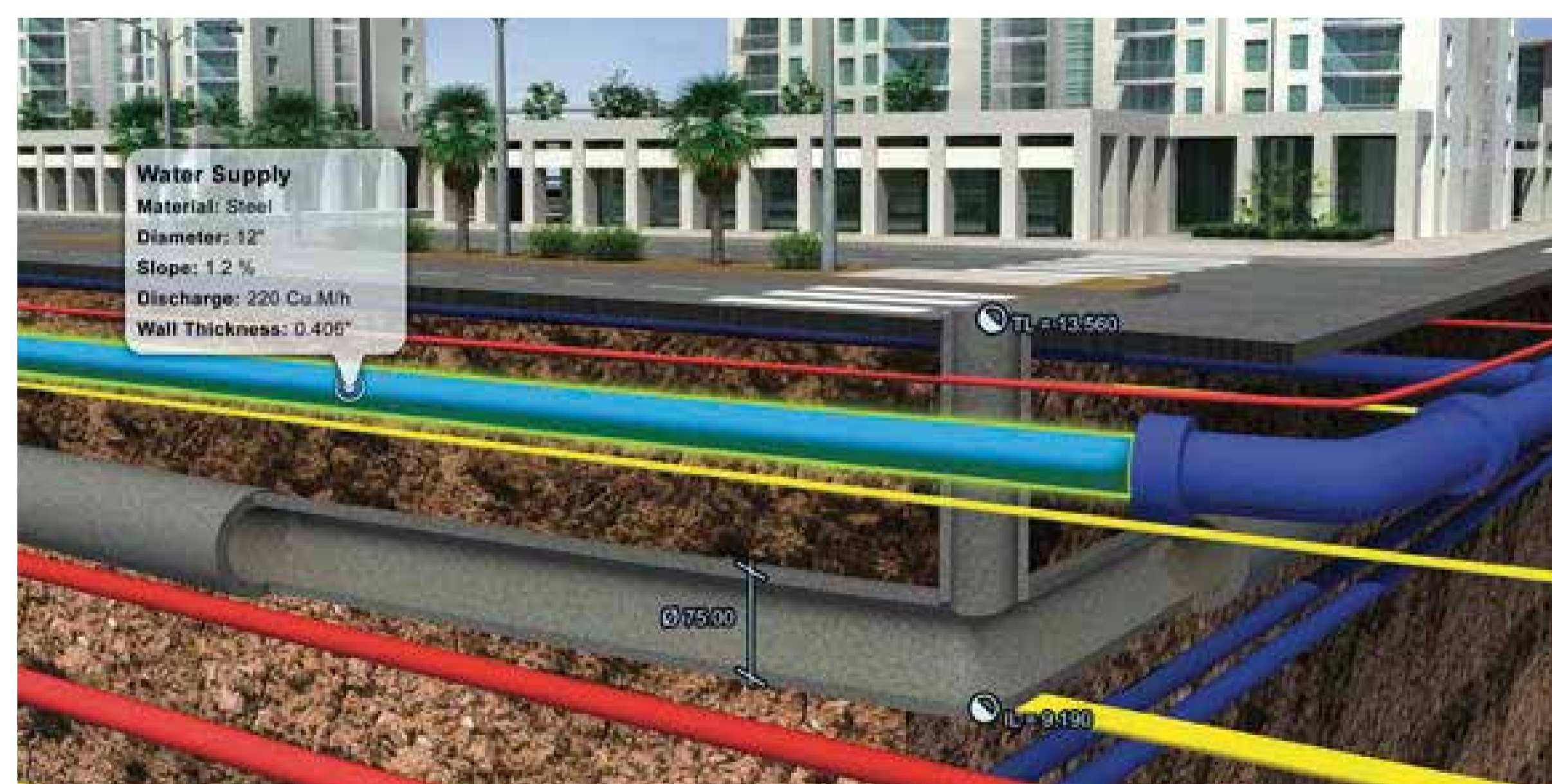
3D GIS informační model města a inženýrských sítí 3D GIS information model of a city and technical infrastructure networks
